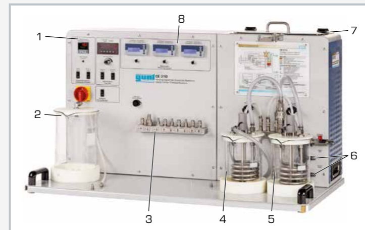
1 éléments d'affichage et de commande, 2 réservoir pour produit, 3 panneau de connexion, 4 et 5 réservoirs pour réactifs, 6 raccord d'eau, 7 réservoir d'eau, 8 affichage de la conductivité et de température
