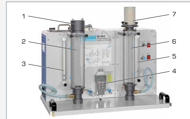
1 alimentation en eau, 2 réservoir d'eau, 3 rotamètre pour l'eau, 4 appareil de mesure portable pour la perte de charge, 5 rotamètre pour l'air, 6 réservoir pour l'air, 7 filtre
