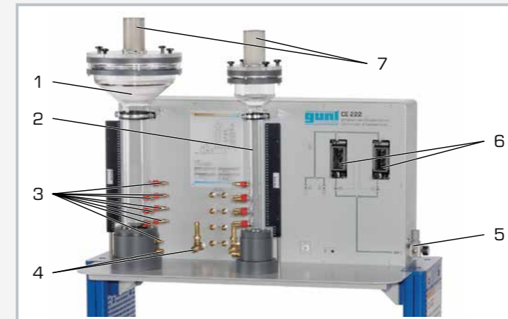
1 colonne K1 avec Ø 100mm, 2 colonne K2 avec Ø 50mm, 3 points de mesure de pression différentielle de K1, 4 alimentation en gaz de K1, 5 alimentation en gaz du banc d'essai, 6 mesure du débit pour 2 plages de mesure
