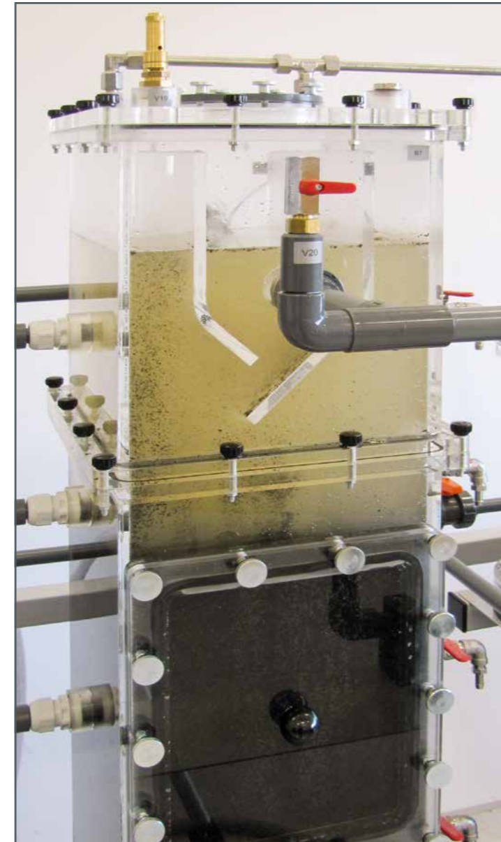
Essai de fonctionnement réussi du réacteur UASB du CE 702 dans notre laboratoire
