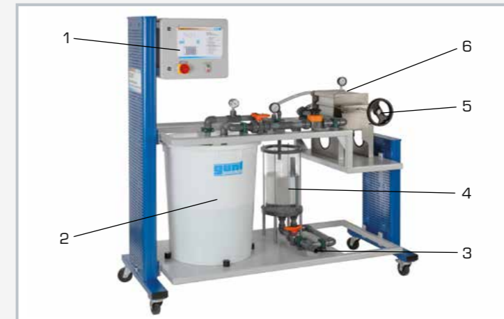
1 coffret de commande avec les éléments de commande, 2 réservoir de la suspension, 3 orifice de sortie et trop-plein réservoir à filtrat, 4 réservoir du filtrat, 5 broche, 6 filtre-pressé à cadres et à plateaux
