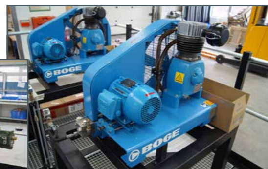
Station d'air comprimé
