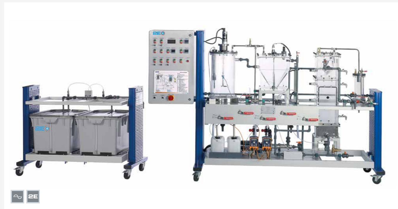
L'illustration montre: unité d'alimentation (à gauche) et banc d'essai (à droite)
