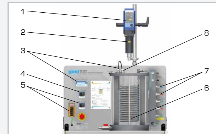
1 agitateur, 2 mesure du couple, 3 mesure de la conductivité électrique, 4 ajustage de la température, 5 ajustage du débit de gaz, 6 serpentin, 7 raccords pour l'eau chaude, l'eau froide et le gaz, 8 raccords libres pour autres instruments de mesure
