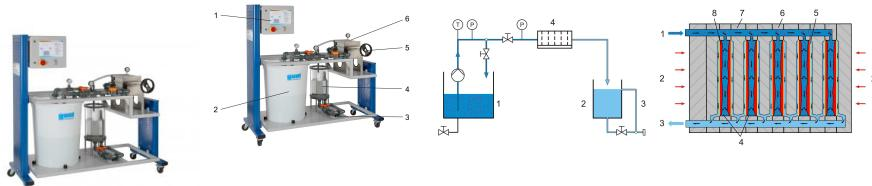
Les filtres-presses à cadres et à plateaux sont utilisés par exemple dans l'industrie des boissons pour clarifier les produits intermédiaires.
