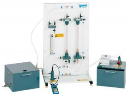
Les échangeurs dions sont utilisés principalement pour la dessalement et l'adoucissement lors du traitement de l'eau.
