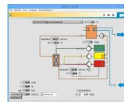
Les réacteurs à écoulement piston sont des réacteurs à écoulement tubulaire et fonctionnent en continu. Ils permettent l'étude de réactions chimiques dans des conditions définies.
