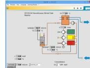
Les réacteurs à cuve agitée sont souvent utilisés en fonctionnement discontinu lorsque les quantités de produit à fabriquer sont faibles, ou que la durée de la réaction est longue.
