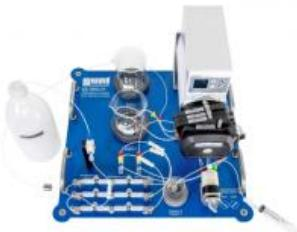
L'analyse par injection en flux continu (FIA - \*F\* low \*I\* njection \*A\* nalysis) complète le CE 380. Elle utilise le photomètre existant dans le CE 380 comme détecteur pour déceler le produit de réaction (glucose). La pompe multi-canaux achemine en permanence trois écoulements de liquide en direction de la FIA. Dans un premier temps, les produits dissous de la réaction de CE 380 sont mélangés dans une chambre avec un réactif de détection.
