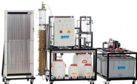
La filtration en profondeur à laide de filtres à sable et l'échange d'ions sont des opérations unitaires importantes du traitement de l'eau.
