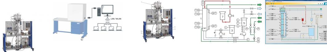
Les réacteurs Airlift sont des réacteurs submergés alimentés en énergie par gazage.
