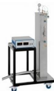
La détermination des pertes thermiques des gaz déchappement est nécessaire pour effectuer le bilan énergétique des moteurs à combustion interne.
