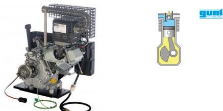
En combinaison avec le banc dessai CT 110, qui renferme une unité de freinage et dentraînement, le moteur essence quatre temps convient parfaitement à lenseignement des principes de base du fonctionnement et de la technique de mesure sur moteurs.
