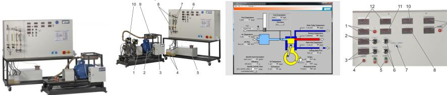
Ce banc dessai permet de mesurer la puissance des moteurs à combustion interne jusqu'à une puissance de 11kW. Le banc dessai complet se compose de deux éléments principaux:
