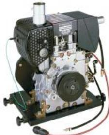
En combinaison avec le banc dessai CT 159 et le dispositif de freinage et dentraînement HM 365, le moteur diesel quatre temps convient parfaitement à l'enseignement des principes de base du fonctionnement et de la technique de mesure sur moteurs.
