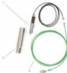
Pour les essais avec indication de pression dans le cylindre sur le moteur de test CT 153, la bougie normale est remplacée par une bougie instrumentée.
