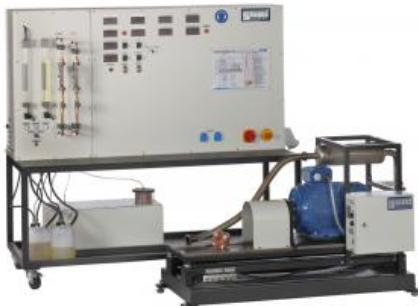
Ce banc dessai permet de mesurer la puissance des moteurs à combustion interne jusqu'à une puissance de 11kW. Le banc dessai complet se compose de deux éléments principaux:
