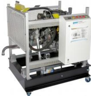
**CT 400.02 Moteur diesel quatre cylindres, diesel à injection directe, 41kW max (Réf. 063.40002)**
