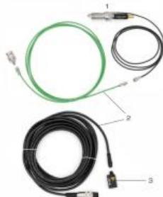
Pour les essais avec indication de pression dans le cylindre sur le moteur de test CT 400.01, la bougie normale est remplacée par une bougie instrumentée.
