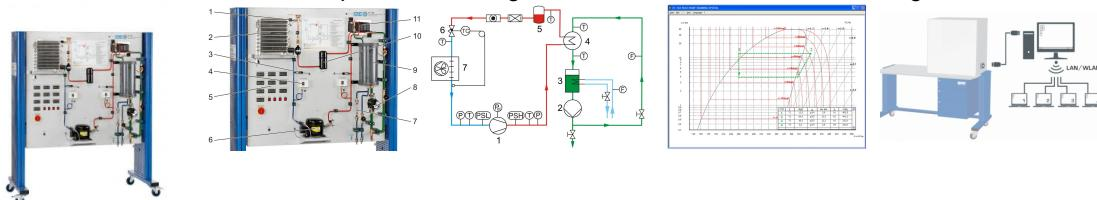
Dans le cas de la pompe à chaleur air-eau ET 102, on utilise la chaleur ambiante pour réchauffer l'eau. Le circuit de la pompe à chaleur se compose d'un compresseur, d'un condenseur avec ventilateur, d'une soupape de détente thermostatique et d'un échangeur de chaleur à serpentin en guise de condenseur. Tous les composants sont disposés de manière visible sur le banc d'essai.
