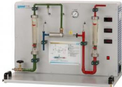
L'appareil d'essai produit de l'air froid et chaud à l'aide d'air comprimé normal.
