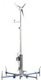
Le rendement d'une éolienne dépend des vitesses du vent et de l'exploitabilité du courant électrique produit. Pour étudier le fonctionnement d'une éolienne dans des conditions météorologiques réelles, on a développé l'ET 220.01. L'ET 220.01 peut être utilisé avec l'appareil d'essai ET 220 ou l'appareil de commande ET 220.10.
