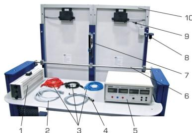
1 résistance à courant, 2 câble d'alimentation, 3 jeu de câbles pour le montage en série et en parallèle, 4 câble de mesure, 5 amplificateur de mesure, 6 aise rétractable, 7 gradomètre, 8 enregistreur de l'éclairement, 9 capteur de température, 10 modules solaires
