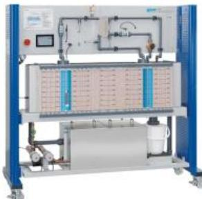
La géothermie est l'étude et l'exploitation de la chaleur et de la distribution de la température dans la terre. Dans une installation géothermique de surface, on exploite l'énergie thermique accumulée sous la surface terrestre.
