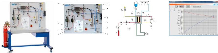
Les piles à combustible sont des convertisseurs d'énergie, qui, à la différence des moteurs thermiques, transforment directement l'énergie chimique en énergie électrique.
