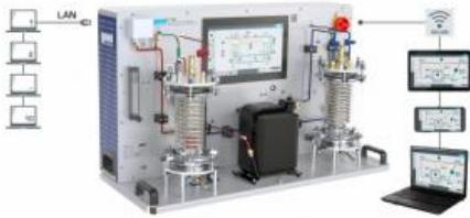
Dans une installation frigorifique à compression, un agent réfrigérant circule dans le circuit frigorifique et connaît différents changements d'état.
