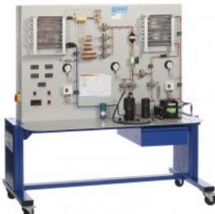
**ET 411C Installation frigorifique PAC avec 3 tubes capillaires, vanne détente (Réf.061.411C0)**
