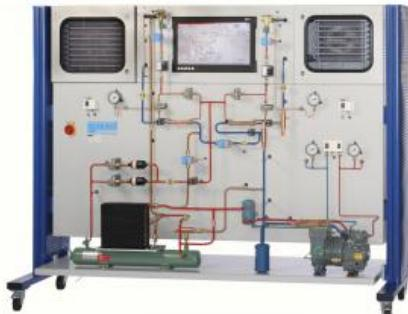
**ET 422 Installation frigorifique, régulation de puissance,
