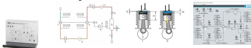
Cet appareil d'essai permet de varier les paramètres du processus telles que la cylindrée, le volume mort, la vitesse de rotation ou l'état d'aspiration de l'air.
