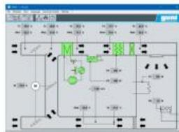
Le logiciel contient une acquisition des données et un régulateur de climatisation, qui permet l'automatisation de l'installation de climatisation ET 605.
