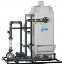
Cette tour de refroidissement par voie humide s'intègre dans le circuit d'eau de refroidissement de la centrale thermique à vapeur ET 833. Elle permet le refroidissement en circuit fermé de l'eau de refroidissement du condensateur de la centrale thermique à vapeur. Les pertes par évaporation sont compensées automatiquement. La température, l'humidité de l'air et le débit d'eau à l'entrée et à la sortie de la tour de refroidissement peuvent être lus directement sur l'appareil.
