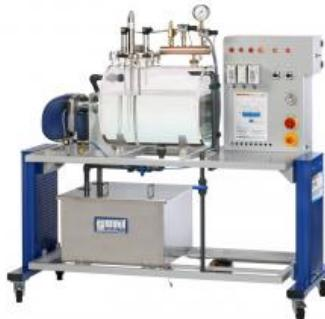
Dans une chaudière à vapeur, la pression et la température augmentent sous l'effet d'un apport permanent en énergie, si bien que la phase liquide du milieu, le plus souvent de l'eau, se transforme en phase vapeur.
