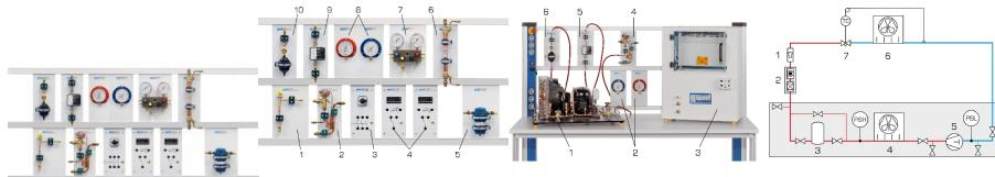
Le ET 910.10 permet la réalisation, avec les ET 910, ET 910.05 et le kit d'accessoires ET 910.12, d'essais de base variés en génie frigorifique.
