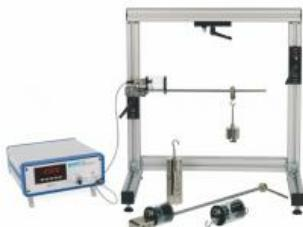
Les jauge de contrainte sont largement utilisées en tant que capteurs pour l'enregistrement de forces, moments et déformations.
