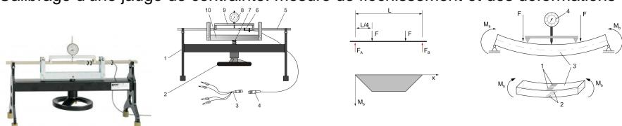
Utilisés comme outils universels dans l'analyse des contraintes expérimentales, les jauge de contrainte offrent la possibilité de transformer les grandeurs mécaniques en grandeurs électriques.
