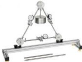
Le FL 111 représente un treillis idéal. Dans le système plan, les barres sont soumises uniquement à la compression et à la traction.
