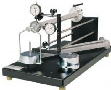
La flexion droite d'une poutre, également appelée flexion axiale, survient lorsque le plan de charge coïncide avec l'un des axes principaux de la section de poutre.
