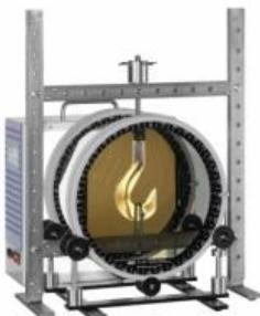
La photoélasticimétrie est une méthode éprouvée d'analyse et de enregistrement des contraintes mécaniques dans les composants.
