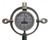
Avec ce dynamomètre universel, les forces de traction ou de compression peuvent être mesurés en fonction de la position de montage.
