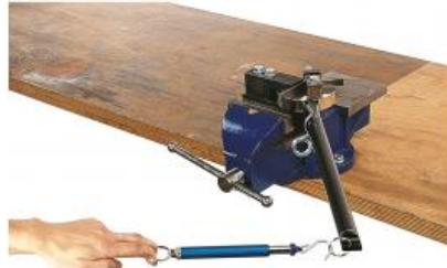
Le montage expérimental permet la réalisation dessais fondamentaux sur la technique de formage. Des barreaux plats peuvent être déformés de manière permanente à laide dun simple appareil à plier. Le travail de déformation nécessaire à cet effet, par ex. pour la réalisation dun coude à 90°, est déterminé au cours de lessai via une mesure de la force.
