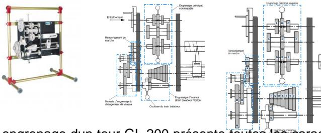
L'engrenage d'un tour GL 200 présente toutes les caractéristiques et propriétés essentielles d'un tour datelier: un engrenage principal commutable, un engrenage d'avance pour l'entraînement de la vis-mère (train baladeur Norton), un harnais d'engrenage à changement de vitesse et un renversement de marche.
