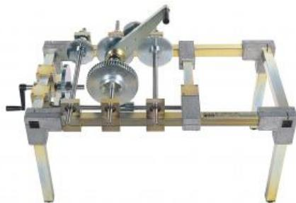
Les boîtes de vitesse sont également appelées variateurs ou harnais d'engrenage à changement de vitesse. Elles se distinguent par le fait que la vitesse de rotation est transmise différemment par diverses paires de roues dentées.
