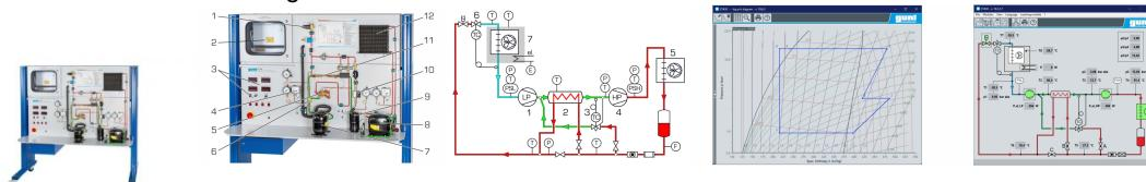
Les installations frigorifiques à deux niveaux de compression sont utilisées dans le cas où des températures particulièrement basses doivent être atteintes.
