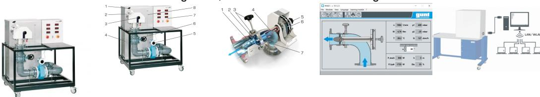
Les turbines à eau sont des turbomachines qui servent à transformer l'énergie de l'eau en énergie mécanique. Dans la plupart des cas, elles sont utilisées pour entraîner des génératrices pour la production électrique. La turbine à hélice est une turbine à réaction à traversée axiale.
