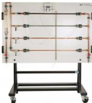
**HL 102 Pertes de charge dans 4 tuyaux différents, longueur, diamètre, rugosité (réf. 065.10200)**
