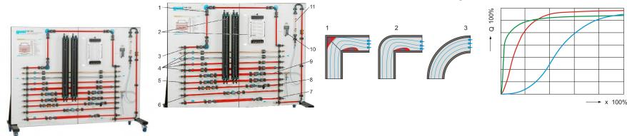
Dans les conduites traversées par un écoulement d'eau, des pertes de charge se produisent suite au frottement du tuyau et aux différents changements de direction.
