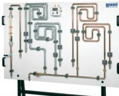
Dans les tuyaux traversés par un écoulement, en plus des pertes de charge suite au frottement du tuyau, on observe également des pertes de charge au niveau des changements de direction de tuyau.
