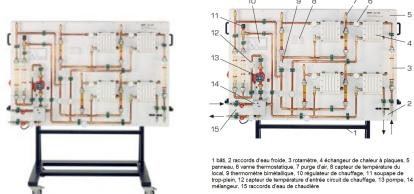
Une pompe de circulation assure la circulation à travers quatre radiateurs dont la température peut être ajustée par des vannes thermostatiques.
