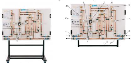
Le banc d'essai a été conçu principalement pour la formation aux techniques de chauffage et sanitaire. Une vanne à trois voies assure dans un système de chauffage la régulation de la température de circulation et d'entrée circuit de chauffage. Une pompe est montée dans le circuit. L'équilibre de pression dans le système est effectuée par le biais d'une soupape de décharge. Des thermomètres à bilame affichent la température à tous les points importants du circuit de chauffage.
