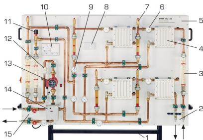
1 bâti, 2 raccords d'eau froide, 3 rotamètre, 4 échangeur de chaleur à plaques, 5 panneau, 6 vanne thermostatique, 7 purge d'air, 8 capteur de température du local, 9 thermomètre bimétallique, 10 régulateur de chauffage, 11 soupape de trop-plein, 12 capteur de température d'entrée circuit de chauffage, 13 pompe, 14 mélangeur, 15 raccords d'eau de chaudière
