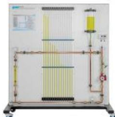
Lors de l'écoulement d'eau au travers d'un système de tuyauterie, des résistances apparaissent sous l'effet de changements de direction, de robinetteries et du frottement du tuyau.
