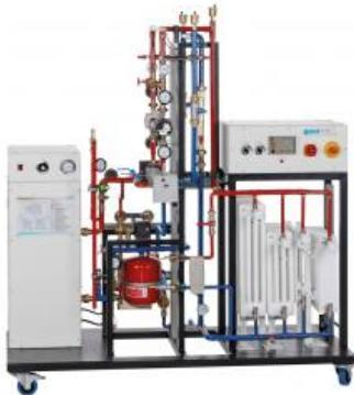
**HL 300 Chaudière électrique 15 kW avec installation de chauffage, radiateurs, vannes (065.30000)
