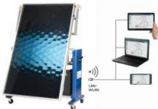
Le banc d'essai HL 313 permet de montrer les principaux aspects du réchauffement des eaux industrielles par héliothermie.
