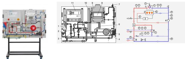
HL 530 illustre le fonctionnement d'une chaudière murale à double service (chauffage/eau chaude) à gaz. Les composants principaux de la chaudière murale à gaz sont disposés de manière claire sur un panneau afin de faciliter la compréhension.
