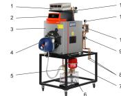
Le banc d'essai est équipé d'un brûleur à fioul.
