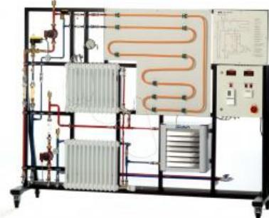
Le banc d'essai HL 353.01 permet le montage d'une installation de chauffage complète en combinaison avec un système de production d'eau chaude comme par exemple le HL 353.
