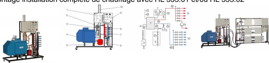
Le HL 353 pour la production d'eau chaude sert d'unité d'alimentation pour les bancs d'essai HL 353.01 et HL 353.02. Il est possible de monter une installation de chauffage complète en combinaison avec les HL 353.01 et/ou HL 353.02. Tous les composants sont usuels en technique de chauffage et offrent un rapport pratique élevé.
