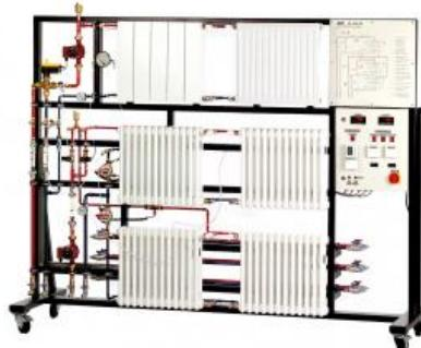
**HL 353.02 Distribution thermique et régulation dans les systèmes de chauffage (Réf. 065.35302)**
