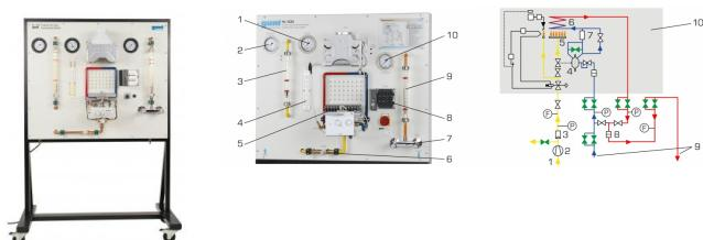
Afin de mettre en évidence la structure de l'appareil, on a enlevé l'enveloppe et le changeur de chaleur du chauffe-eau.
